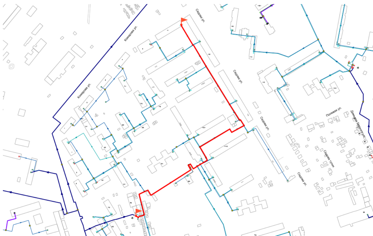
Рисунок 2.15 - Путь теплоносителя по направлению от «ЦТП – 6» до потребителя «ул. Комарова, 11»
